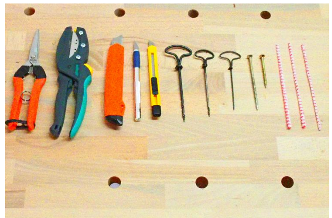
Abbildung 7: Nützliche Werkzeuge zum Versäubern der Öffnungen von Halmen und Röhrchen. Trotzdem: Bringen Sie für diese Arbeit Geduld mit.
